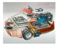
Performances de pointe : rendement de surface jusqu'à 25 000 m²/h en mode balayage avec une largeur de travail de 193 cm (avec deux balais latéraux) et un bac à déchets de 600 l avec vidage en hauteur.
