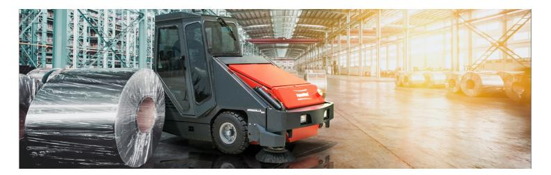
La PowerBoss Armadillo 9XR est une balayeuse haute performance conçue pour travailler dans des conditions difficiles. Dotée d'un entraînement entièrement hydraulique, elle affiche un rendement de surface jusqu'à 25 000 m²/h. Sa largeur de travail atteint 193 cm lorsqu'elle équipée de deux balais latéraux. Elle est capable de franchir les pentes jusqu'à 16 % en mode balayage. La PowerBoss Armadillo : efficacité maximale, une simplicité d'utilisation extrême et une finition impeccable.
