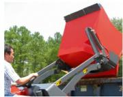
Fonctionnalité totale au quotidien : le bac à déchets en acier inoxydable haute résistance peut être levé jusqu'à une hauteur de 1,62 m.
