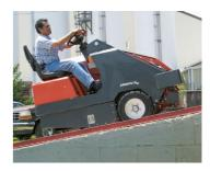
Capacité en côte maximale: grâce à PowerClimb™, la PowerBoss Armadillo est capable de franchir des bordures et des pentes jusqu'à 16 %, également en mode balayage et avec bac à déchets plein.
